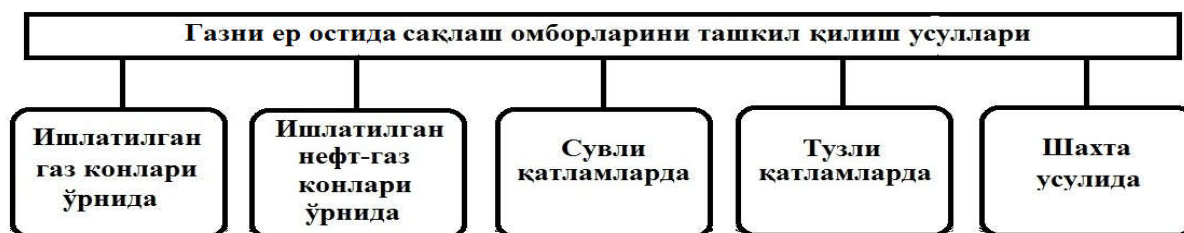
1-расм. Газни ер остида сақлаш иншооти ташкил қилиниши усуллари
